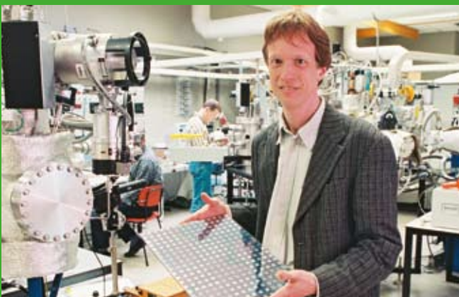
In het Utrecht Solar Energy Laboratory wordt de productietechnologie van een dunne film zonnecellen onderzocht. Professor Ruud Schropp toont een zonnecel gemaakt van dunne film silicium op glas.
