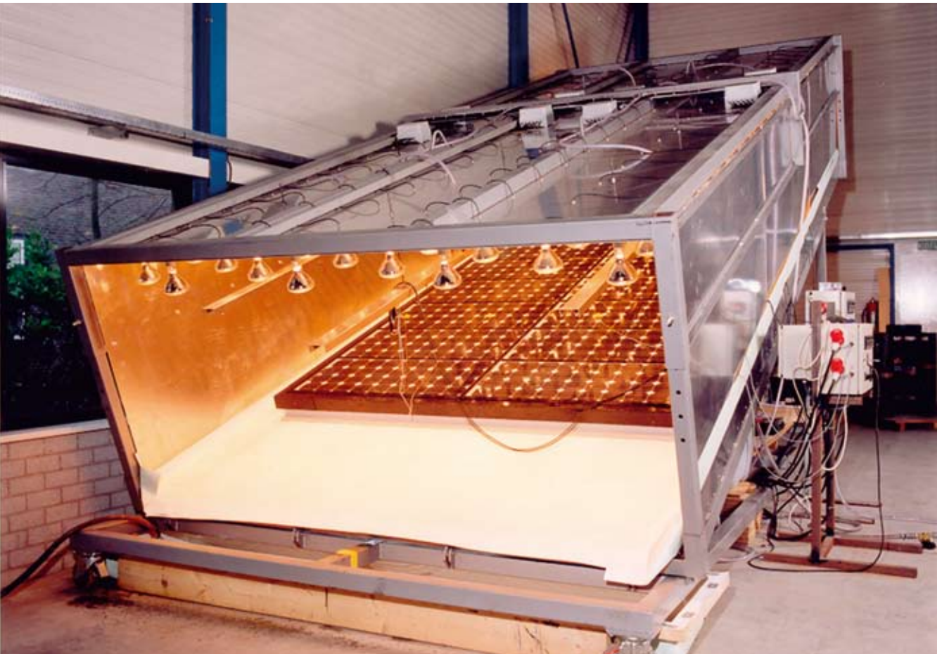
Testen van een prototype van een montagesysteem voor zonnepanelen bij BDA Dakadvies: brandproef en thermoshock.
