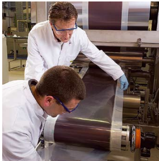
De ontwikkeling van flexibele 'roll-to-roll' zonnecellen door Nuon
